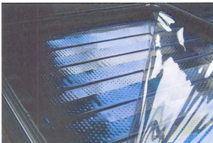
Ansicht des Absorbers und der Teflonfolie view of absorber and teflon foil
